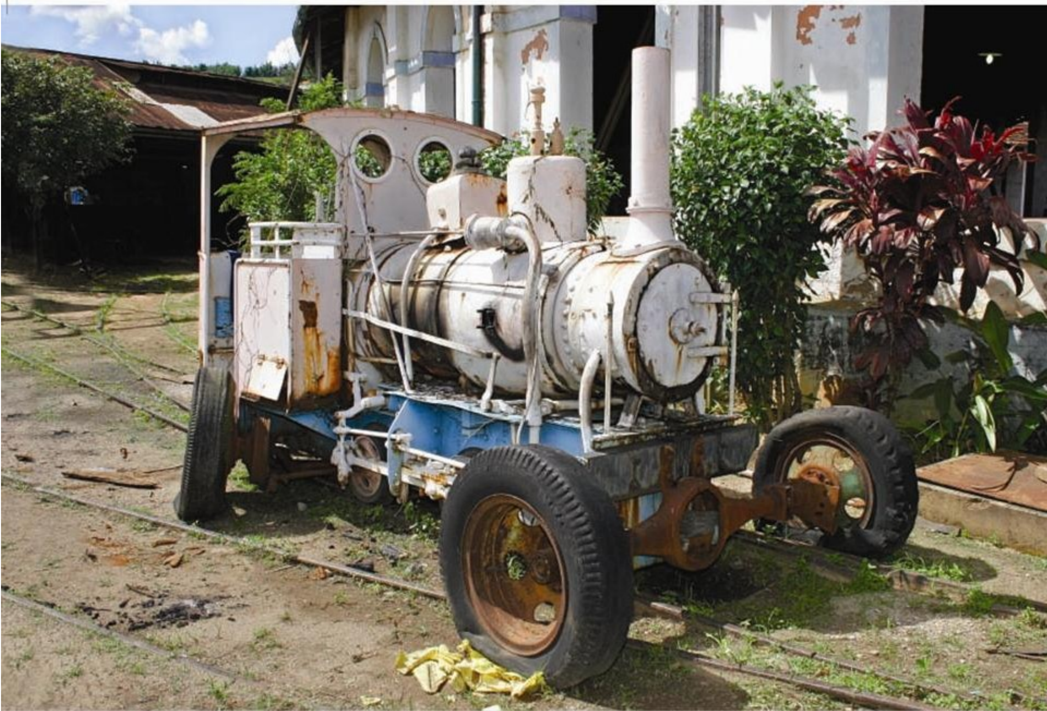
A Orenstein & Koppel de 1912 ganhou pneus de caminhão e está numa oficina em Além Paraíba (MG). FICHA 36 This 1912 Orestein & Koppel received truck fires and is now at a shop in Além Paraíba (MG). CARD 36
